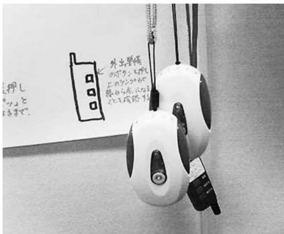
写真14 非常通報システムの送信機
